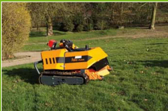
La RoboFlail accepte trois plateaux de tonte différents, un pour l'herbe et deux pour les broussailles.
