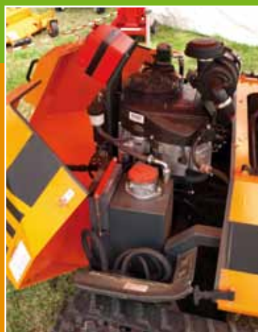
Cœur de la machine, le moteur Kawasaki essence de 25 ch bénéficie d'un circuit de lubrification amélioré.
