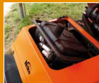
Monté sur un cadre à balancier, le réservoir conserve son niveau quand la pente augmente.
